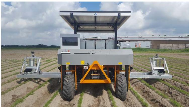
Der Jäte-Roboter des Startups Naiture ist solar-elektrisch angetrieben und kann mittels einer künstlichen Intelligenz zwischen Beikraut und Möhrenkraut unterscheiden.
