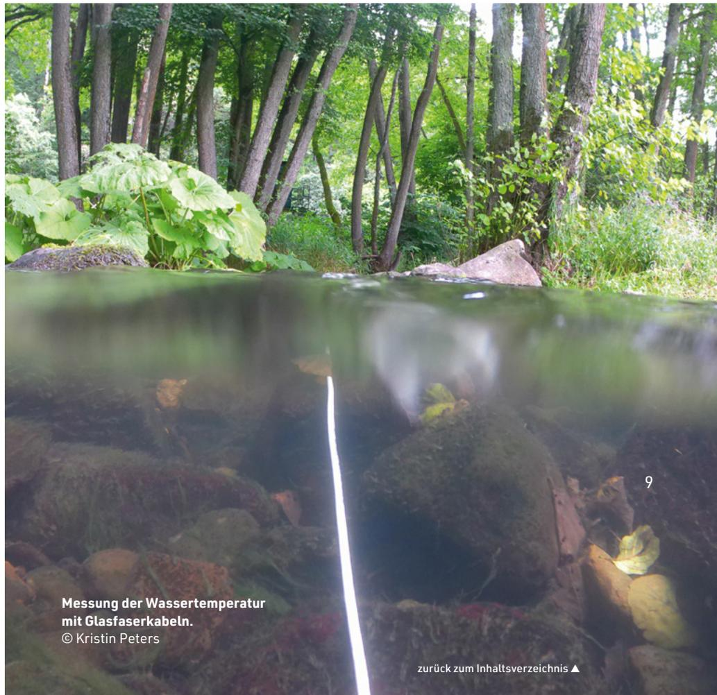
Messung der Wassertemperatur mit Glasfaserkabeln.
