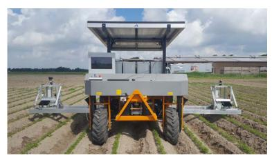
Der Jäte-Roboter des Startups Naiture ist solar-elektrisch angetrieben uns kann mittels einer künstlichen Intelligenz zwischen Beikraut und Möhrenkraut unterscheiden.
